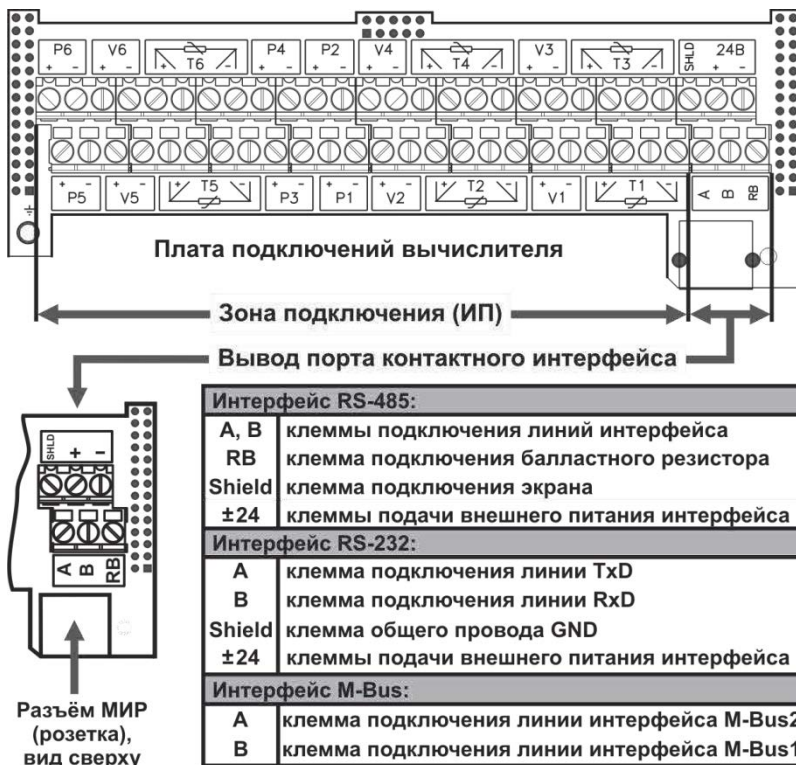
Рисунок 1.5 – Подключение вычислителя к контактным интерфейсам посредством проводной линии связи
